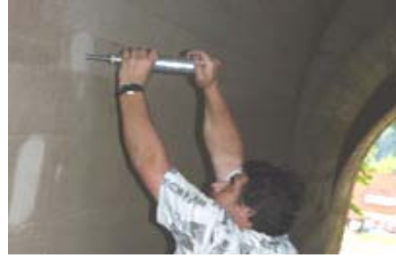
شكل (8.4): الفحص بالمطرقة الخاصة. نماذج واستخدامات لمطرقة Schmidt hammer test فحص القوة
