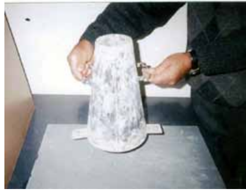
شكل (6.4): فحص الباطون في الموقع قبل عملية الصب اختبار التهدل أو الهبوط باستخدام المخروط
