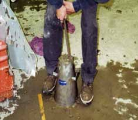
شكل (6.4): فحص الباطون في الموقع قبل عملية الصب اختبار التهدل أو الهبوط باستخدام المخروط
