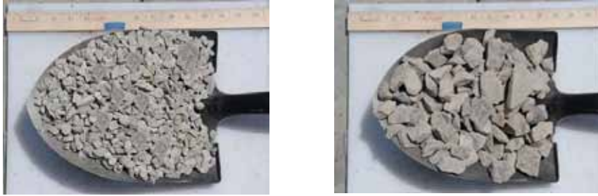
شكل (2.4): تدرج الركام - استخدام ركام بمقاسات وأحجام مختلفة يخفف من نسبة الفراغات في الخلطة الواحدة
